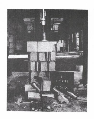
PHOTO 3 - TYPICAL FAILURE OF AXIALLY LOADED WALL
